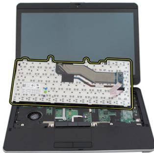
9. Rimuovere il nastro mylar che fissa il cavo dati della tastiera al retro della tastiera.
