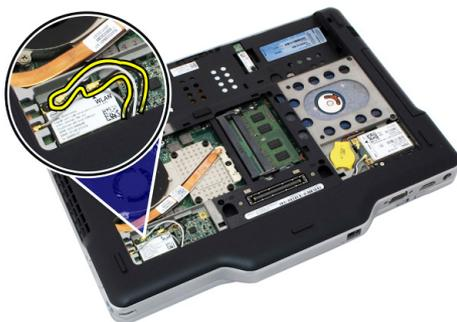
5. Rimuovere la vite di fissaggio della scheda WLAN alla scheda di sistema.
