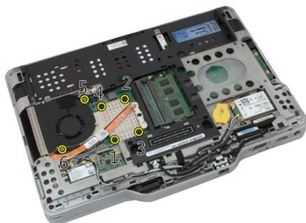
8. Sollevare il dissipatore di calore ed estrarlo dal computer.
